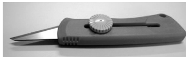
愛媛大学での授業で使用している小刀 エヌティー株式会社「ステンレスナイフ」VM-2P 替え刃は両刃・片刃ともに販売されている
